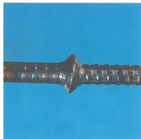
アセット溶接
